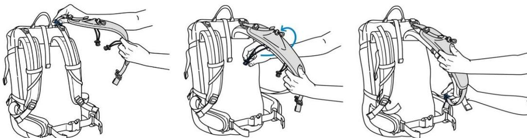
ショルダーハーネスの付け根、スタビライザーストラップの縫い付け部分にフォトポケットの上部フックを引っ掛けます。スタビライザーストラップがないモデルの場合は、持ち手部分に上部フックを引っ掛けます。
