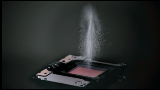
ダストリダクションシステム
